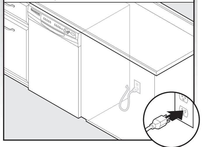
Brancher la fiche du cordon d'alimentation sur une prise de courant reliée à la terre, à 3 alvéoles. Vérifier que le cordon d'alimentation n'entre pas en contact avec le moteur du lave-vaisselle ou la partie inférieure de la cuve.
